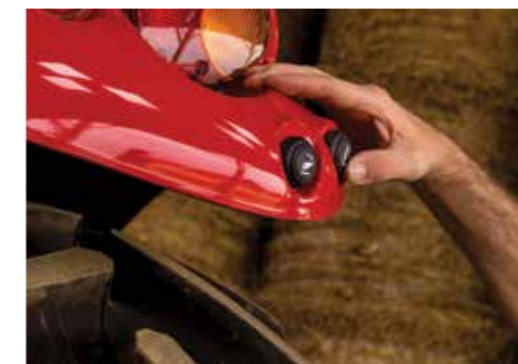
Auf dem Kotflügel montierte Tasten zur Heckhubwerksteuerung
