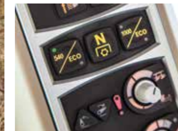
Elektrohydraulisch vorgewählte Zapfwellendrehzahl
