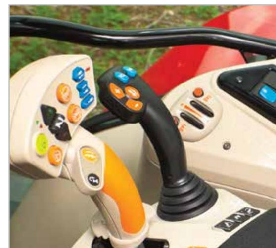
„Der Vorteil dieses Joysticks liegt darin, die Fahrtrichtung zu wechseln oder die Geschwindigkeit zu verändern und gleichzeitig den Frontlader bedienen zu können, ohne Ihre Hand vom Lenkrad nehmen oder zwischen verschiedenen Bedienhebeln wechseln zu müssen.“
