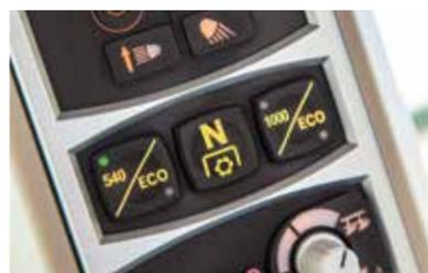
Eine elektrohydraulische Anwahl der Zapfwelldrehzahl auf der rechten Säule ist optional erhältlich
