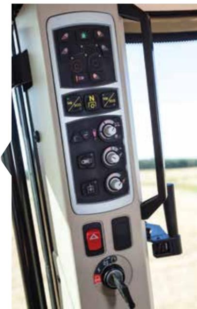
Alle Schalter am rechten Platz. Weniger häufig genutzt, aber dennoch ein wichtiger Bestandteil Ihres Arbeitstags – auf der rechten Säule befinden sich die Schalter für die Arbeitsleuchten, die optionale Anwahl der Heckzapfwelle, die Heckhubwerkregelung und der Schalter für die neue Hydraulikfunktion mit kombiniertem Durchfluss von 100 l/min.
