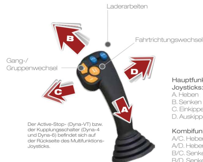
Der Active-Stop- (Dyna-VT) bzw. der Kupplungsschalter (Dyna-4 und Dyna-6) befindet sich auf der Rückseite des Multifunktions-Joysticks.
